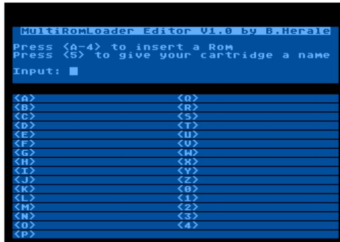
Mit der Taste „5“ kann dem Modul einen eigenen Namen mit einer Länge von 20 Zeichen vergeben werden. Es schaltet ein Feld mit den Begrenzungen „>“ „<“ ein. Zwischen diesen wird der Text eingegeben und zeitgleich im unteren dunklen Namenfeld übertragen. Nach anschließender Bestätigung mit „Y“ werden die Daten ins Modul geschrieben und Freigabe der die Taste „5“ gesperrt.
