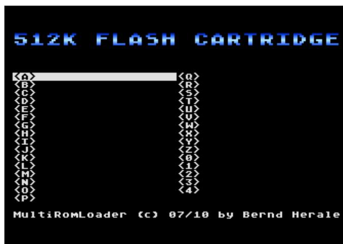
Alle Menüpunkte sind in dieser Phase gesperrt, ein Booten von Diskette ist nicht freigegeben. Mit dem Halten der Option Taste und Drücken der Reset Taste am Atari wird das Flash MegaCart Modul ausgeschaltet und der Rechner bootet von der Diskette.
